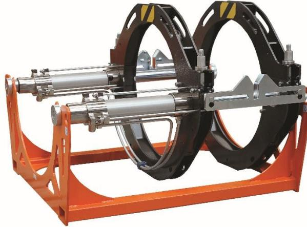
La **COMPACT 630** est une machine manuelle de soudage par miroir hydraulique, adaptée au soudage de systèmes de tuyauterie sous pression pour l'eau, le gaz ou d'autres fluides. La machine a une portée de **280 à 630 mm** et est construite selon les normes internationales (UNI 10565, ISO 12176-1).
