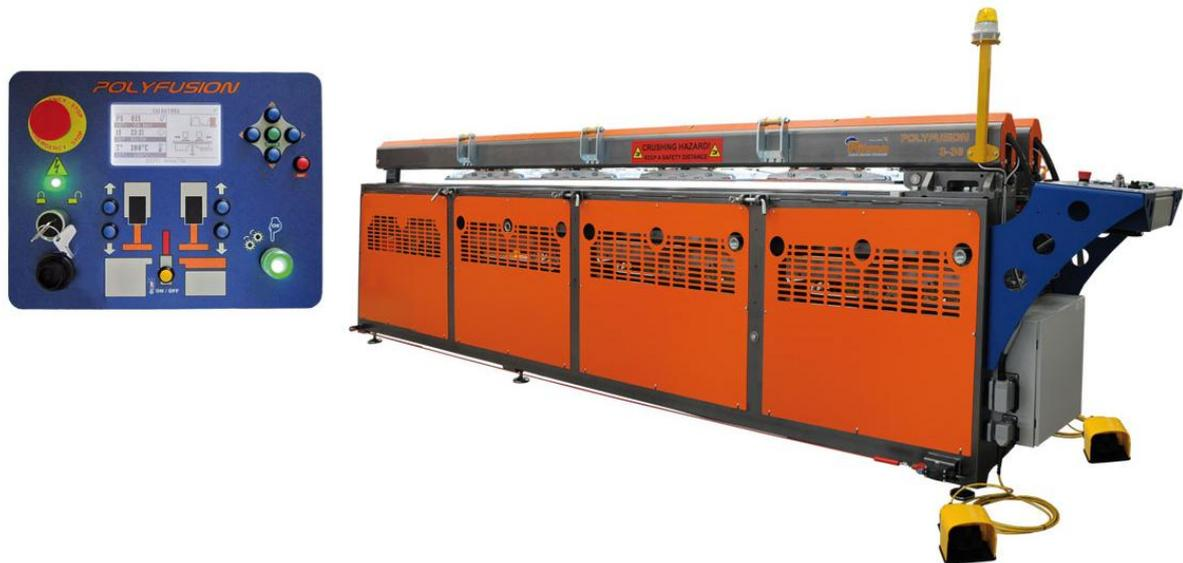
La **POLYFUSION 3-30** est une machine de soudage à miroir hydraulique de **3 mètres** de large et facile à utiliser , adaptée au soudage de plaques en plastique **jusqu'à 30 mm d'épaisseur**. Le processus de soudage est contrôlé par CNC par un automate, qui fonctionne selon DVS 2207. La machine peut souder des plaques droites, des angles à 90 ° et des cylindres.
