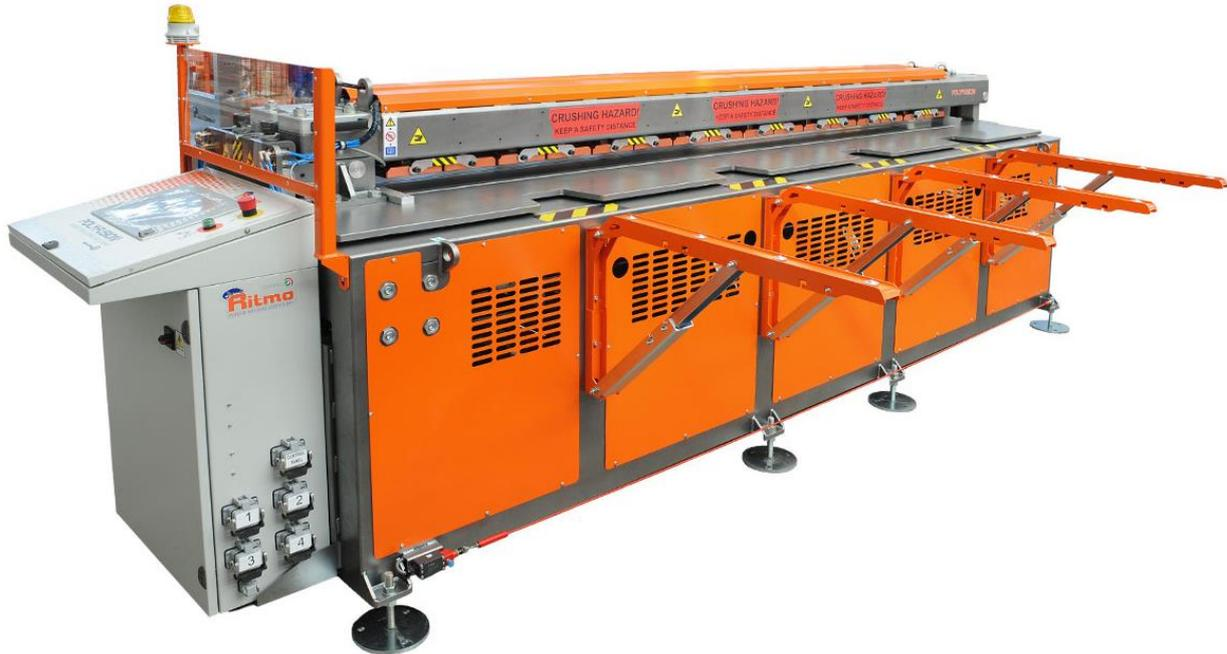
La **POLYFUSION 4** est une machine de soudage à miroir par entraînement pneumatique de **4 mètres** de largeur et facile à utiliser, adaptée au soudage de **plaques** de plastique **jusqu'à 50 mm d'épaisseur (double paroi de 60 mm)**. Le processus de soudage est contrôlé par CNC par un automate, qui fonctionne selon DVS 2207. La machine peut souder des plaques droites, des angles 90 ° et des cylindres.
