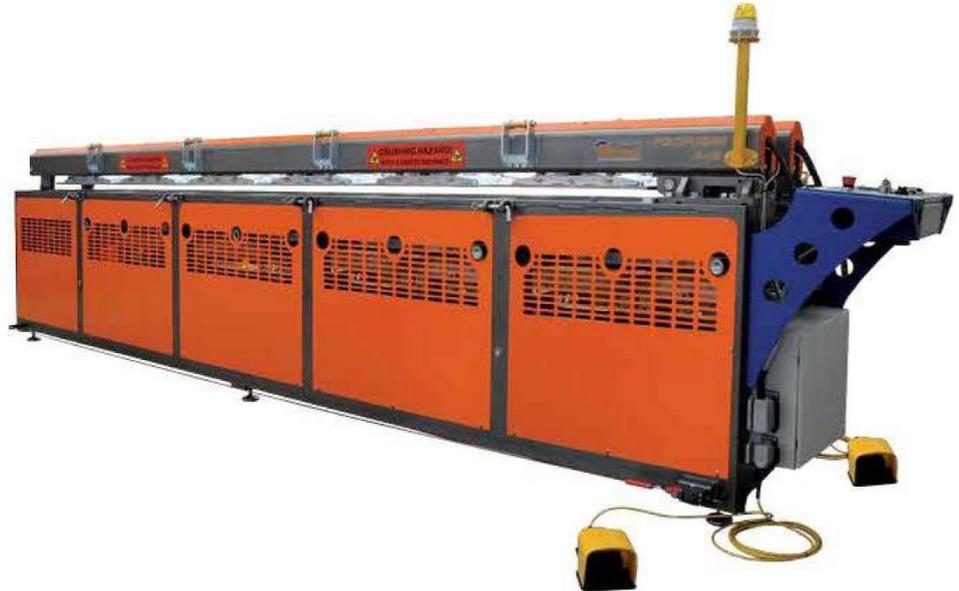
La **POLYFUSION 4-30** est une machine de soudage à miroir hydraulique de **4 mètres** de large et facile à utiliser , adaptée au soudage de **feuilles** de plastique **jusqu'à 30 mm d'épaisseur**. Le processus de soudage est contrôlé par CNC par un automate, qui fonctionne selon DVS 2207. La machine peut souder des plaques droites, des angles à 90 ° et des cylindres.
