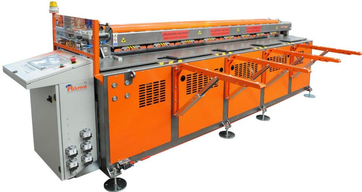
La **POLYFUSION 3** est une machine de soudage à miroir à entraînement pneumatique de **3 mètres** de large et facile à utiliser , adaptée au soudage de plaques en plastique **jusqu'à 50 mm d'épaisseur (double paroi 60 mm)**. Le processus de soudage est contrôlé par CNC par un automate, qui fonctionne selon DVS 2207. La machine peut souder des plaques droites, des angles à 90 ° et des cylindres.
