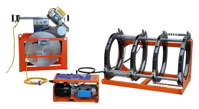
La **DELTA 500** est une machine de soudage manuelle à miroir hydraulique, adaptée au soudage de systèmes de tuyaux sous pression pour l'eau, le gaz ou d'autres milieux. La machine a une plage de **200 à 500 mm** et est construite selon les normes internationales (UNI 10565, ISO 12176-1).
