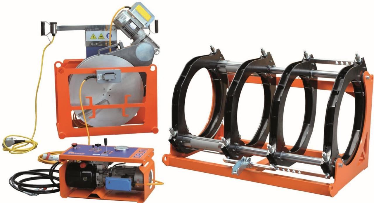
La **DELTA 630** est une machine de soudage manuelle à miroir hydraulique, adaptée au soudage de systèmes de tuyaux sous pression pour l'eau, le gaz ou d'autres milieux. La machine a une plage de **280 à 630 mm** et est construite selon les normes internationales (UNI 10565, ISO 12176-1).
