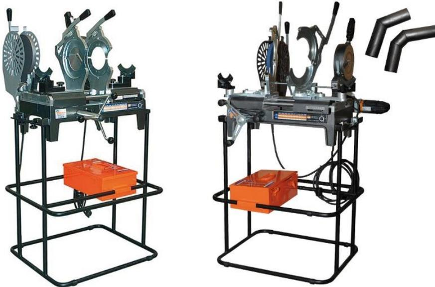
Ces appareils sont des machines de soudage à miroir portables pour les tuyaux de vidange jusqu'à **160mm**. Ils se caractérisent par la plaque chauffante coulissante, les microcommutateurs de sécurité sur la fraise pour éviter tout démarrage accidentel et les supports latéraux articulés.
