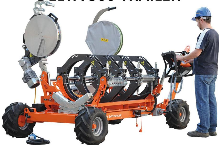
La **DELTA 500 TRAILER** est une machine de soudage à miroir hydraulique auto-alignante, adaptée au soudage de tuyaux sous pression pour l'eau, le gaz et d'autres liquides, pour des diamètres de **200 à 500 mm**. Cette machine fonctionne selon les normes internationales ISO 21307 HAUTE PRESSION et ASTM F2620. La **DELTA 500 TRAILER** n'a pas de générateur à bord et a besoin d'une alimentation externe.
