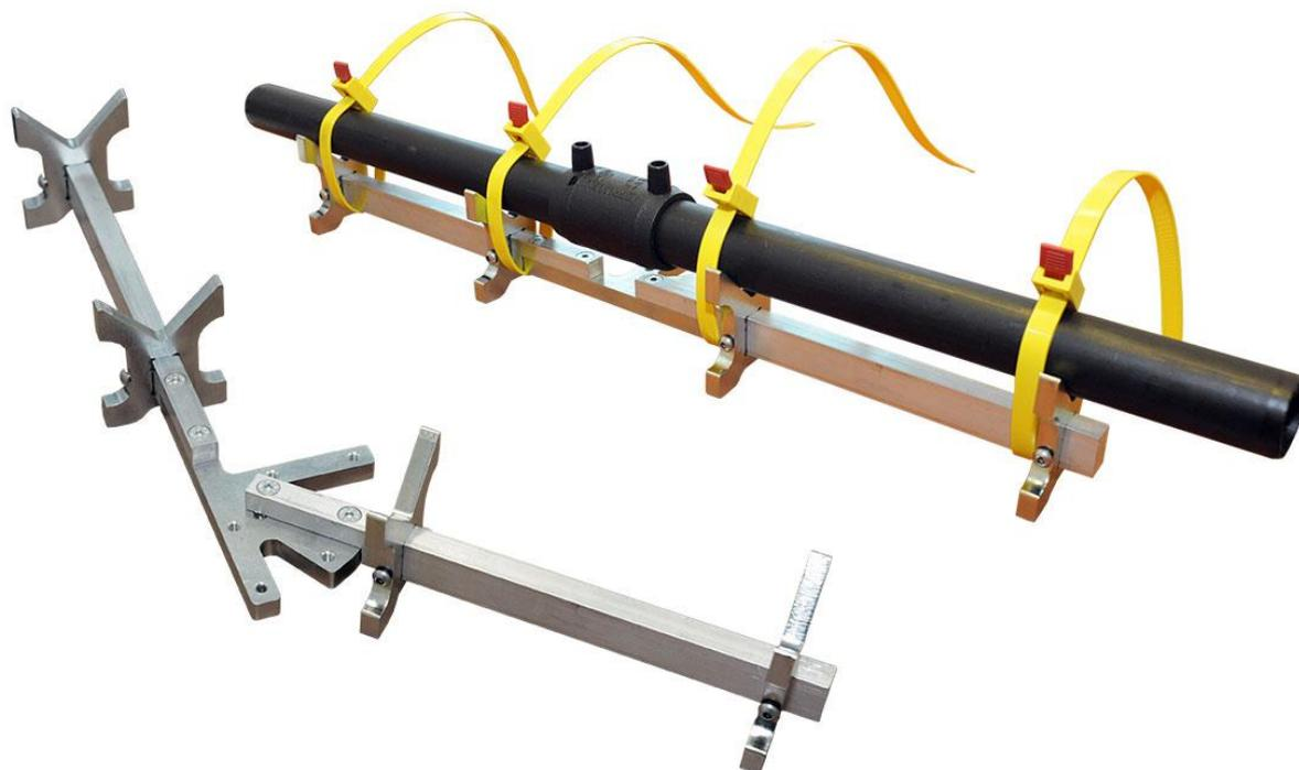
L'**ALIGNER ECO 20-63** est un outil essentiel et professionnel pour l'alignement des tuyaux lors de l'électro-soudage. Il est composé de 2 bras en aluminium avec des pinces en acier autocentrantes. Les pinces peuvent facilement être déplacées le long du bras. Une plaque de positionnement permet le soudage en 30°, 45°, 90° et des pièces T avec des diamètres compris entre **20 et 63mm**.
