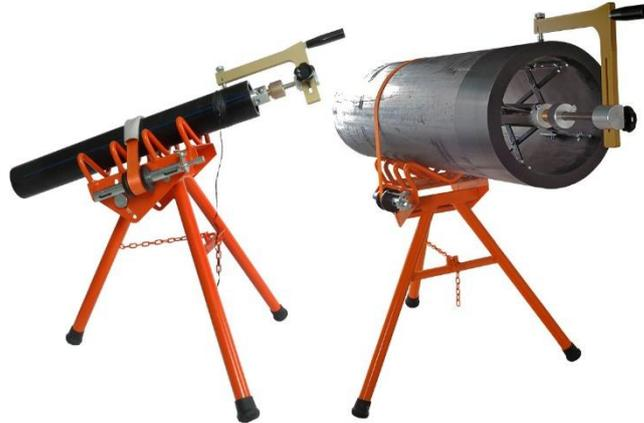
Avec cet outil pratique, le tube peut être verrouillé. Cela permet à l'opérateur d'effectuer rapidement et précisément toutes les opérations menant au cycle de soudage (découpe, décapage, grattage, etc.)
