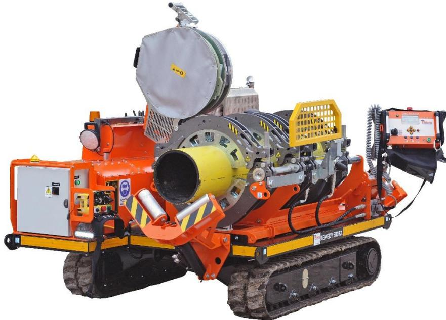
Cette machine à souder est utilisée sur place, elle dispose d'un moteur diesel à faible vibration et de chenilles. La machine convient au soudage de tuyaux sous pression en plastique pour le transport d'eau, de gaz et d'autres liquides. Il peut traiter des tuyaux d'un diamètre de 250 à 500 mm et a été construit selon les normes internationales.
