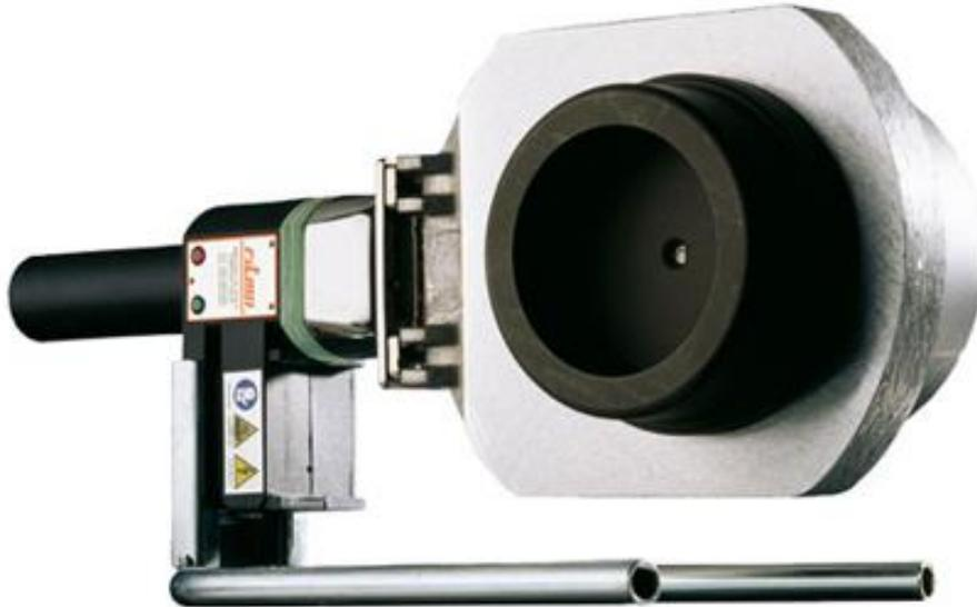
Le dispositif de soudage dans l'emboîture **R125Q** est équipé d'une plaque chauffante en aluminium et d'une poignée en plastique pratique résistante à la chaleur. Il convient aux tuyaux et raccords en PEHD, PP et PVDF. Les numéros de type se réfèrent aux diamètres maximaux des tubes. La machine est disponible avec un thermorégulateur électronique réglable (TE) ou avec un thermostat électronique fixe (TFE).
